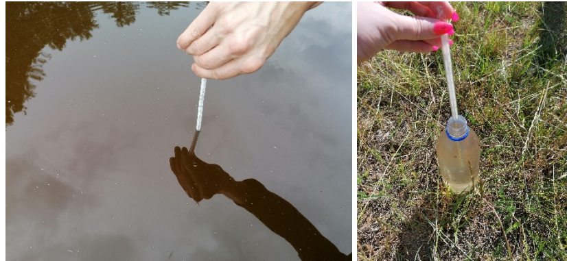
2.2 pav. Vandens mėginio temperatūros matavimas ėmimo vietoje
