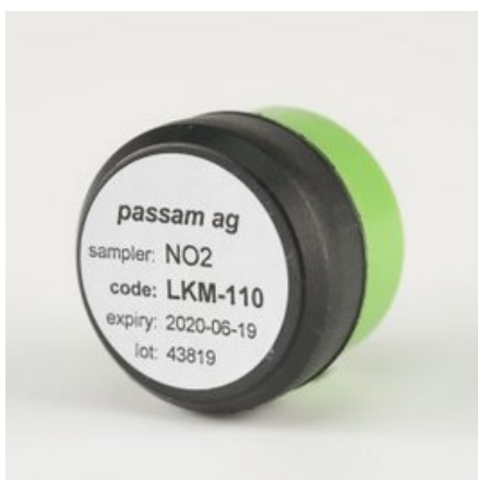
1.4 pav. Azoto dioksido pasyvusis sorbentas (kaupiklis)
