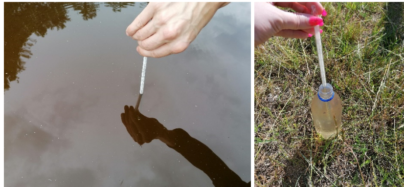
2.2 pav. Vandens mėginio temperatūros matavimas ėmimo vietoje
