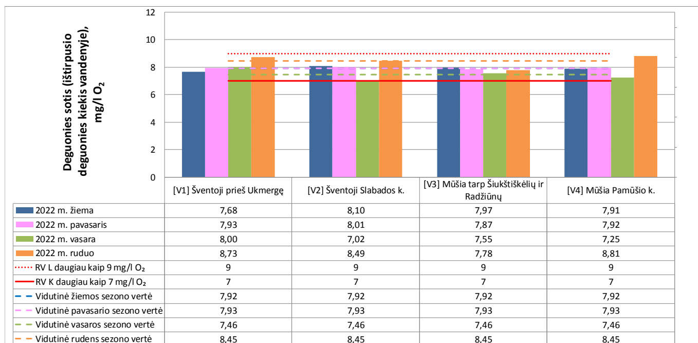
2.4 pav. Deguonies sotis paviršiniame vandens telkinyje (RV L – ribinė vertė lašišiniams vandens telkiniams daugiau kaip 9 mg/l O 2 , RV K – ribinė vertė karpiniams vandens telkiniams daugiau kaip 7 mg/l O 2 )
