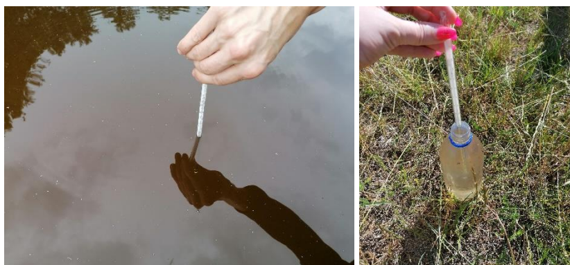
2.2 pav. Vandens mėginio temperatūros matavimas ėmimo vietoje
